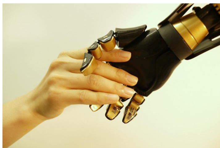
Mão humana aperta mão robótica com mecanorreceptores artificiais (Foto: Bao Research Group/Stanford University)
